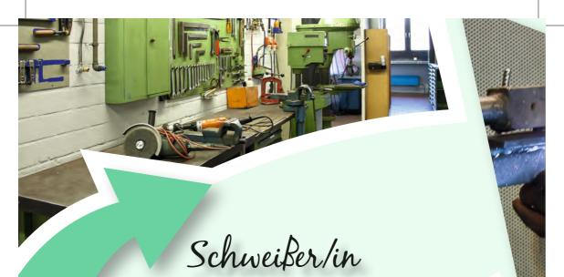
chweißer und Schweißerinnen verbinden unterschiedliche Metalle mit unterschiedlichen Schweißverfahren. Dazu müssen sie über gute Materialkenntnisse verfügen und die verschiedenen Verfahren beherrschen: Rohre sind anders zu schweißen als Bleche. Baustähle sind einfacher zu verarbeiten als Chrom-Nickel-Stähle. Auch die Dicke der zu schweißenden Stücke ist von Bedeutung und erfordert bestimmte Arbeitstechniken.
